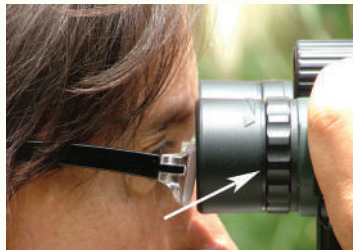
Foto 3. Si usas anteojos manten sin extender los anillos, así tus ojos quedarán más cercanos a los oculares.
