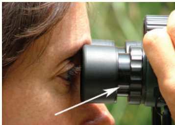
Foto 2. Si no usas anteojos, extiende los anillos oculares, así las pestañas no tocarán los oculares.
